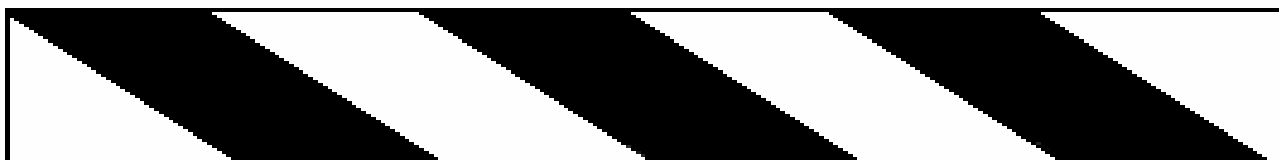
Figur 5: Spæringsafmærkning. Striberne skal være lige brede og hælde 45 grader.
